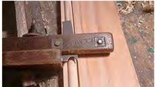
Le tarabiscot est un outil utilisé par le menuisier et l'ébéniste. Intermédiaire entre le rabot et le racloir, il permet de créer une ou plusieurs gorges dans une pièce de bois selon un profil courbe.
