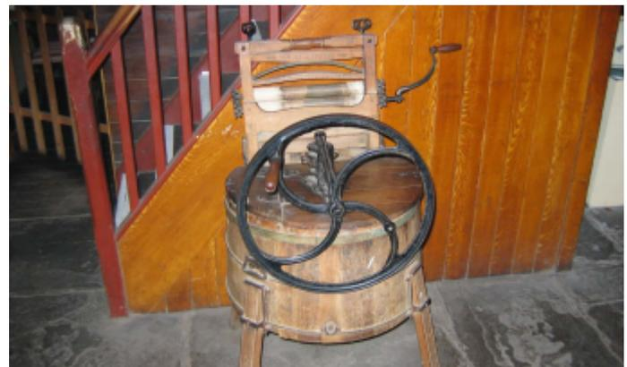
Lessiveuse manuelle avec essoreuse dans laquelle on verse le lissu très chaud
