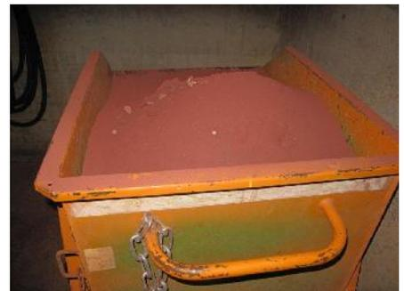
*Cendres à la sortie du four de la step de Lausanne. La couleur rouge provient de la présence de chlorure ferrique dans les cendres, produit utilisé dans les step.*
